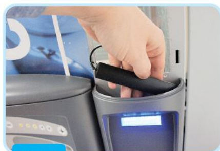
фото 5 Снимите пластик и установите антенну под купюро-приемником.
