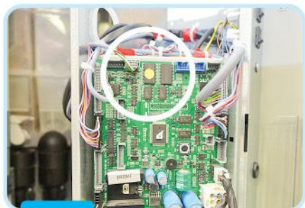
фото 1 Убедитесь, что автомат поддерживает телеметрию. Найдите желтую или зеленую наклейку.
